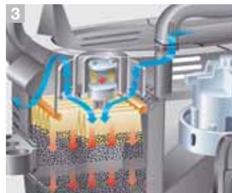
**3 Sistema TACT.** Sistema con 1 filtro plissettato piatto, puliti automaticamente da un getto d'aria. La polvere fine non può bloccare i filtri assicurando un'alta e costante portata d'aria. Oltre 1000 kg di polvere fine possono essere aspirati senza sostituire i filtri.
